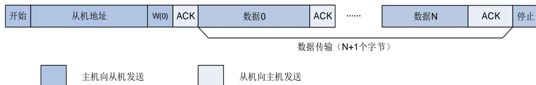
图 22-6. 7 位地址的 I2C 通讯流程（主机接收）
